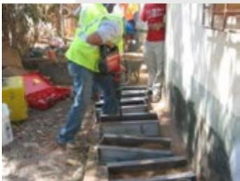
Fabricación de especímenes para verificación de resistencias.
