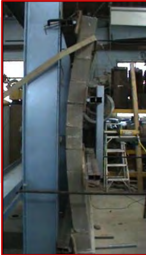
4 Barras de GFRP #4 GFRP
