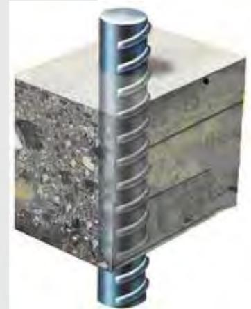
**El acero permanecerá en estado pasivo mientras no se vea afectada la capa pasivante que le otorga el concreto**
