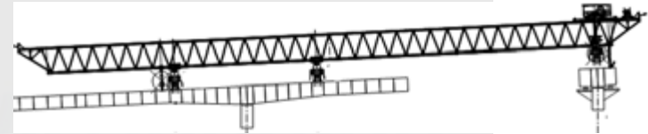
AUTOCIMBRA – PREPARACIÓN A VOLADIZOS SUCESIVOS
