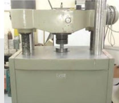
Máquina para ensayo a compresión
