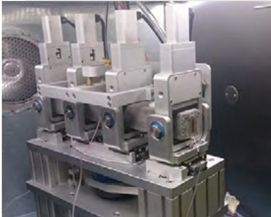
Máquina para ensayo de resistencia a cargas dinámicas
