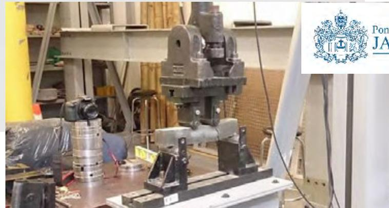
Máquina para ensayo de resistencia a flexión con carga estática
