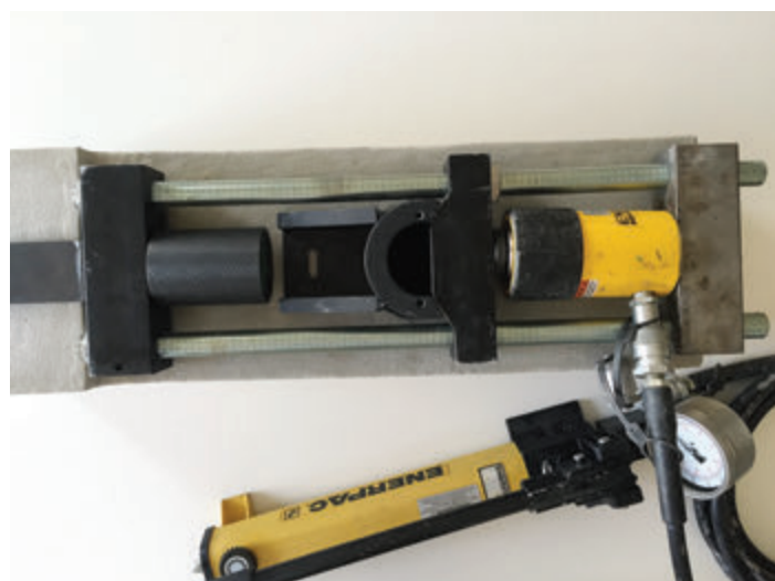
↑ Foto 2. Extremo móvil del sistema de platinas de carbono postensadas. Se ve la platina de carbono y en su extremo la cabeza de fibra de carbono. También se ve el gato hidráulico con el cual se aplica la fuerza de tensionamiento (22 ton).
