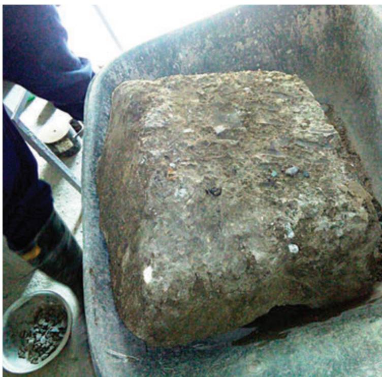
↑ Artesa de concreto lanzado inadecuada. CORTESÍA LABORATORIOS CONTECON URBAR
