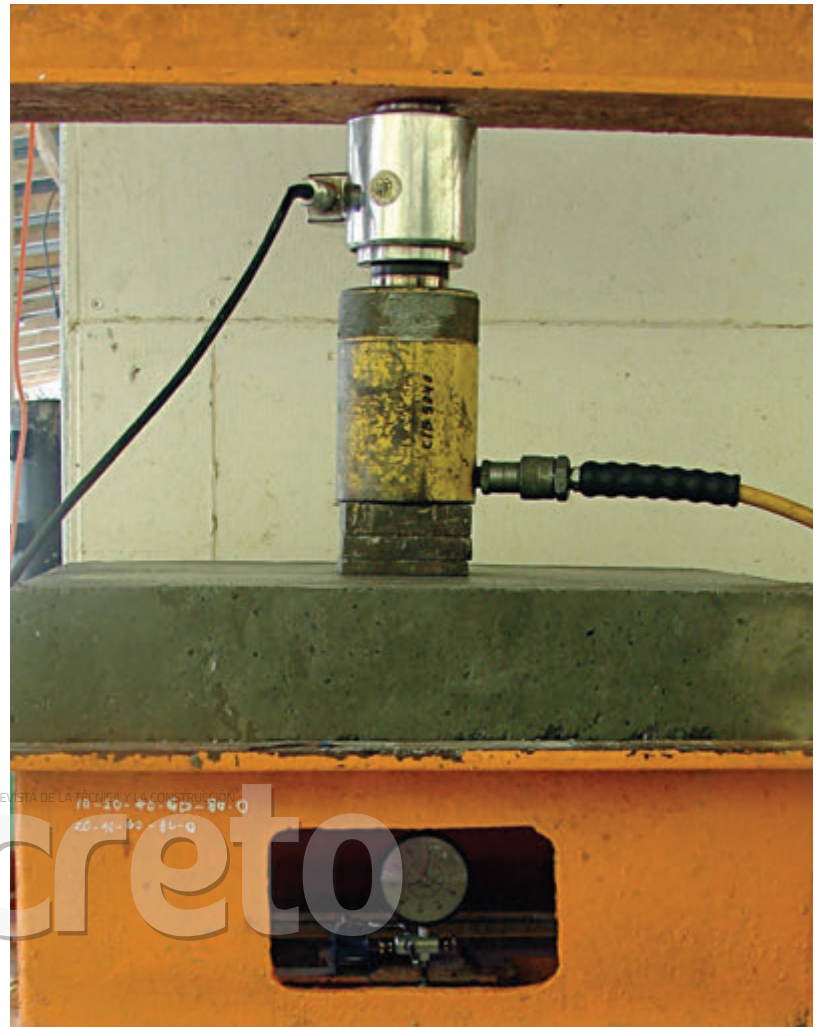
↑ Ensayo de absorción de energía (tenacidad) placas método EFNARC. CORTESÍA LABORATORIOS CONTECON URBAR
